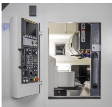
➤ große, seitlich angebrachte Türe ➤ schwenkbares Bedienpult mit integriertem Handrad
